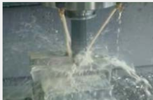
加工状況 Cutting scene (L/D=3.4)
