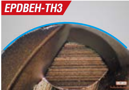
先端部の摩滅が小さい Minimal tip wear
